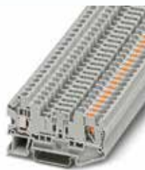
20 А, разделительная клемма, 3 функциональных отверстия и два контрольных гнезда 4 мм
