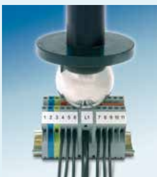
Защита от прикосновения тыльной стороной ладони Испытательный зонд (шар) диаметром 50 мм
