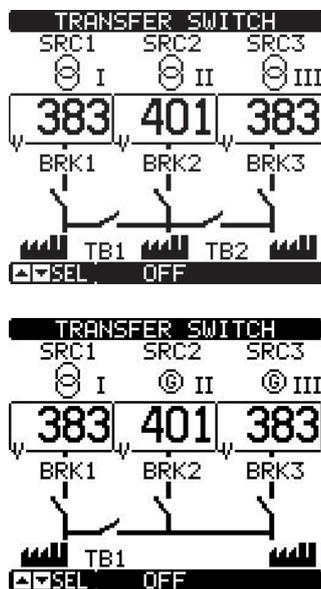
С помощью одного контроллера автоматического ввода резерва можно управлять системами, которые раньше требовали установки нескольких каскадно соединённых контроллеров. Предусмотрено 14 конфигураций системы.
