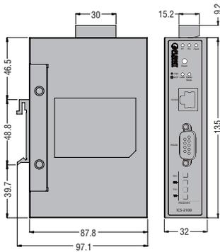
МОДЕМ GSM ДЛЯ ДИСТАНЦИОННОГО УПРАВЛЕНИЯ И МОНИТОРИНГА С ПОМОЩЬЮ SMS
