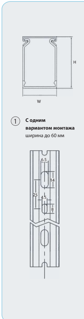
② Стремя вариантами монтажа ширина от 80 до 120 мм (кабельные каналы из ПВХ)
