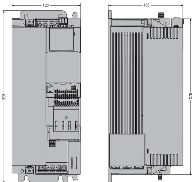
❶ Размеры указаны для укомплектованных приводов, включающих в себя силовой модуль VLB3...A480XX, логический модуль VLBXL... и модуль управления VLBXC...
