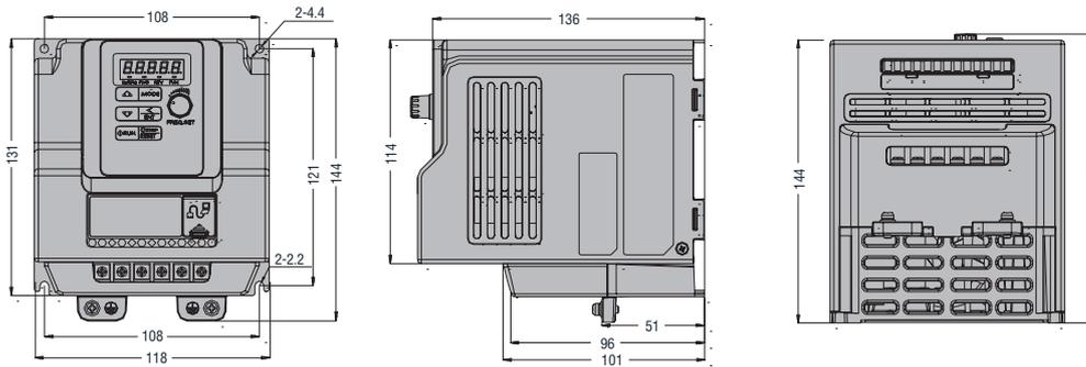
ОДНОФАЗНЫЕ ЧАСТОТНО РЕГУЛИРУЕМЫЕ ПРИВОДЫ СЕРИИ VLA1
