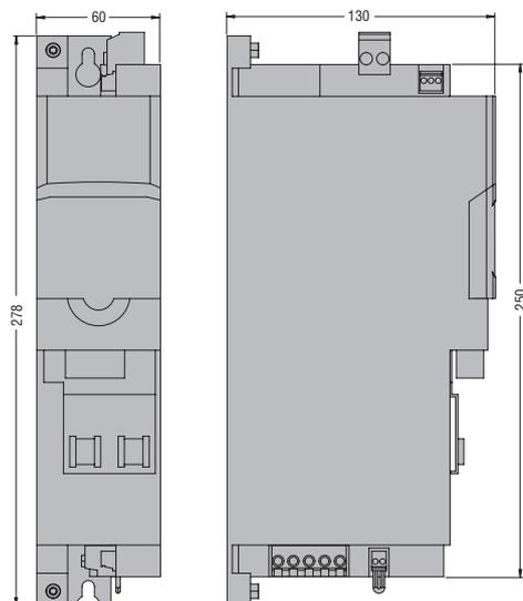
❶ Размеры указаны для укомплектованных приводов, включающих в себя силовой модуль VLB1...A240XX, логический модуль VLBXL... и модуль управления VLBXC...
