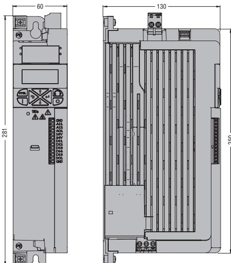
Однофазные частотно регулируемые приводы с расширенными функциями серии VLB1 **VLB104A240**
