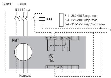
● Способ подключения катушки может отличаться в зависимости от типа подсоединённого устройства (контактора, выключателя с катушкой расцепления или выключателя с катушкой минимального напряжения).
