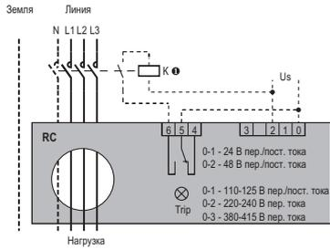
❶ Способ подключения катушки может отличаться в зависимости от типа подсоединённого устройства (контактора, выключателя с катушкой расцепления или выключателя с катушкой минимального напряжения).
