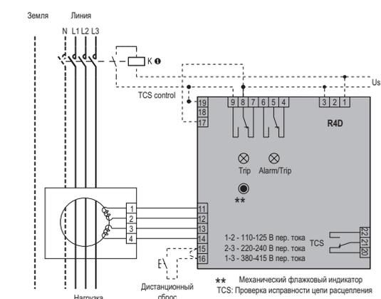
● Способ подключения катушки может отличаться в зависимости от типа подсоединённого устройства (контактора, выключателя с катушкой расцепления или выключателя с катушкой минимального напряжения).
