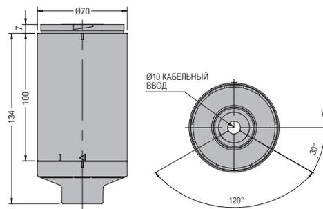
**Модули кабельной разводки с непосредственным винтовым креплением**
