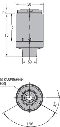
Модули кабельной разводки с непосредственным винтовым креплением
